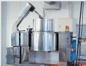
電気回転釜 かりんとう種・水飴炊き上げ用 (攪拌機付き)
